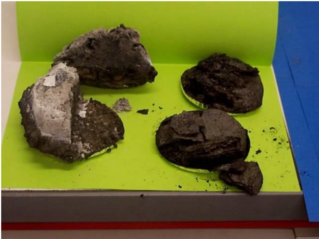
Figure 12 : peinture intumescents après essai au cône calorimètre à 50 kW/m 2
